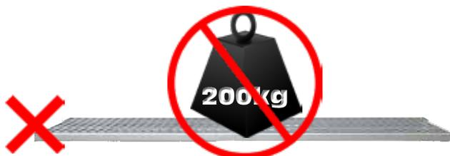
\*рассчитано на равномерно распределённую нагрузку на рамы без угловых соединений
